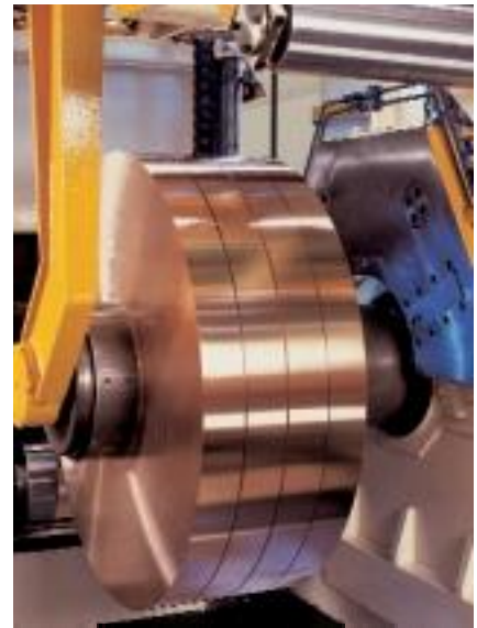
Kupferband ist ein qualitativ hochwertiges Vormaterial für die Herstellung von Koaxialkabeln.
